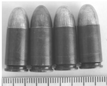
Рис. 1. Самодельные патроны, собранные при помощи укороченной гильзы калибра 5,45x39мм военных патронов к автомату АК-74 и пуля 9x19мм от патронов Парабеллум.
